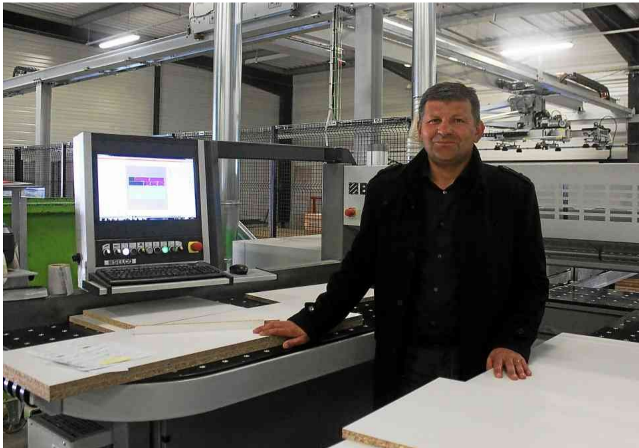
La nouvelle acquisition de Didier Benon, le robot picking, permet d'économiser un poste et de gagner en efficacité et en ergonomie, puisque la machine prélève elle-même les panneaux bois nécessaires.
